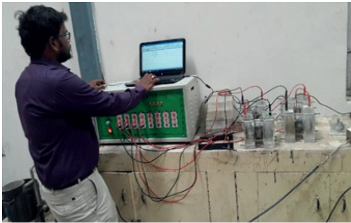
Rys. 11. Stanowisko badawcze przepuszczalności chlorków metodą przyspieszoną
